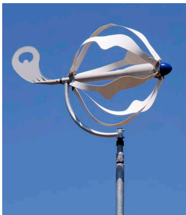
PLUS RARE : AXE HORIZONTAL SELON LE PRINCIPE DES "AILES BATTANTES".
