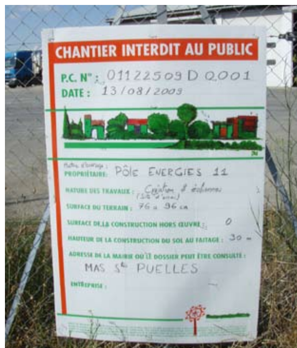
IL EST OBLIGATOIRE D'AFFICHER L'OBTENTION DU PERMIS DE CONSTRUIRE, SUR LE SITE, AVEC UN PANNEAU VISIBLE DE LA VOIE PUBLIQUE.
